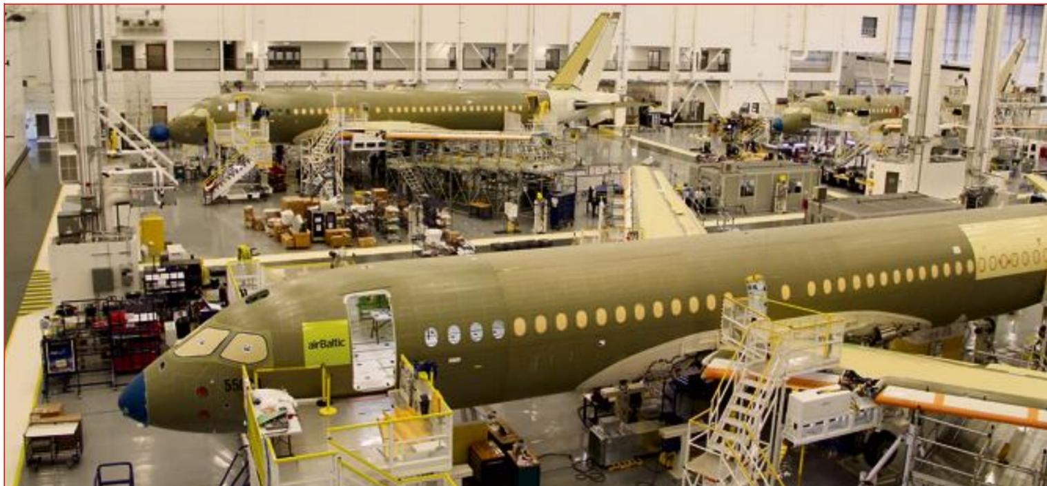
Eine CS300 (vorne) und eine CS100 sind in der letzten Produktionsreihe angelangt. Die Flügel sind montiert, bald geht es zum Innenausbau und dann zur Testanlage.
