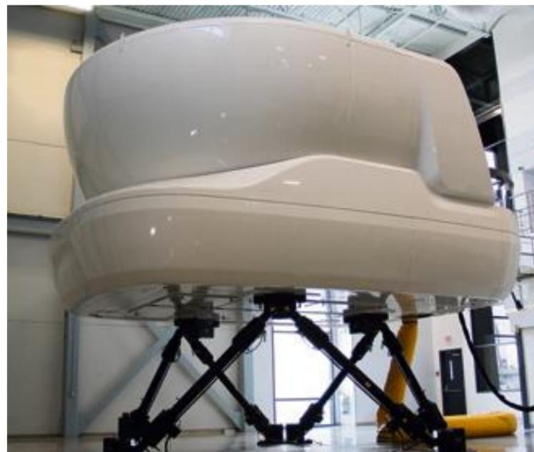
In Montreal trainieren die Swiss-Piloten in diesem Full-Flight-C-Series-Simulator für den Ernstesatz.
